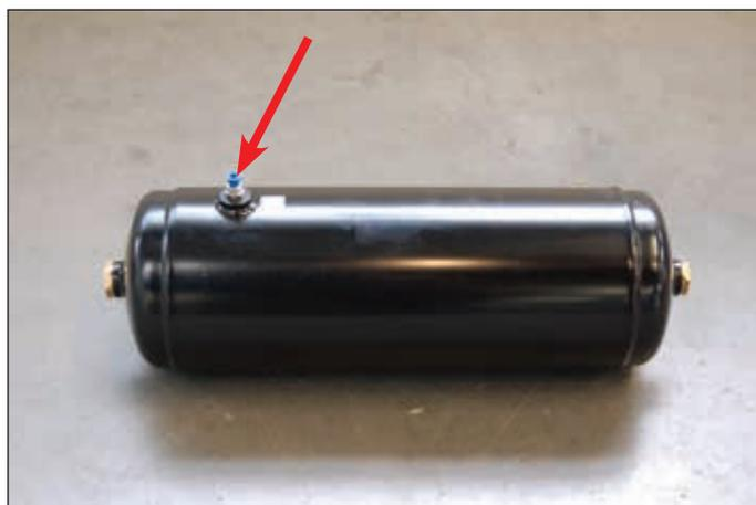
6. Установите воздушный резервуар на кронштейн воздушного резервуара.
