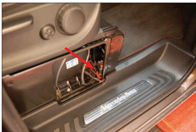
20. Подключите желтый и коричневый провод к точке заземления.
