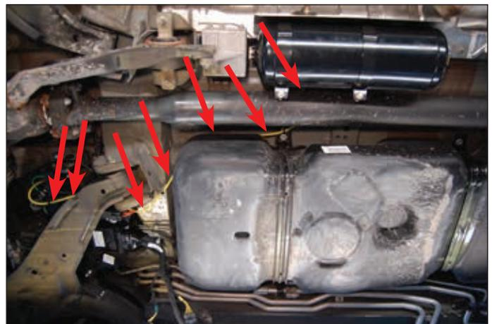
10. Подключите желтый пневмопровод к блоку клапанов.
