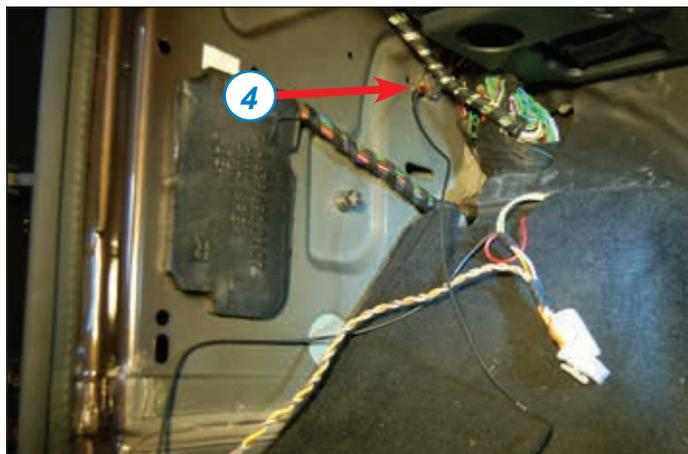
5. Подключите розовый провод к свободному месту на клемме аккумулятора.
