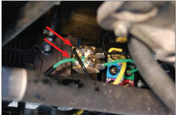
3. Если комплект аварийных вентилях отсутствует, запечатайте неиспользуемые пневматические муфты с помощью прилагаемых торцевых заглушек.
