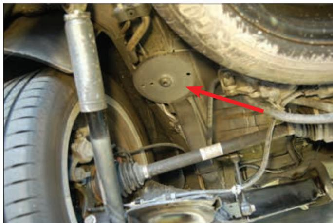
5. Установите одну колпачковую заклепочную гайку М8 в положение, показанное на шасси (инструмент, рекомендуемый VB, Fabory F612).
