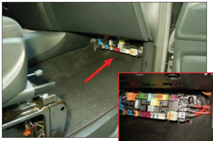
3. Подключите розовый кабель к синему держатель предохранителя.
