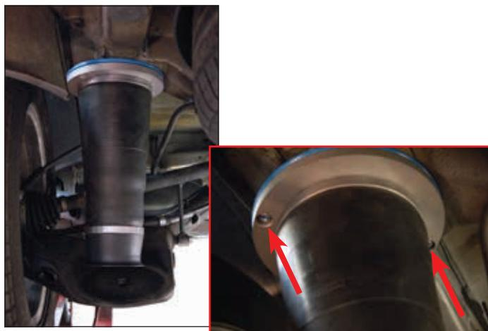
3. Установите нижний конец пневматической рессоры на заднюю ось.
