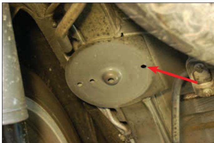
**2 x Колпачковая заклепочная гайка М8**
